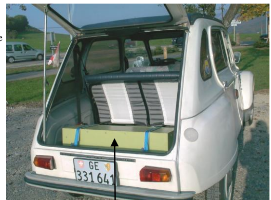
Batterie Lithium-Polymère (traction / freinage) Électrique (7,6 KWh – 75 kg – autonomie 70 km)
