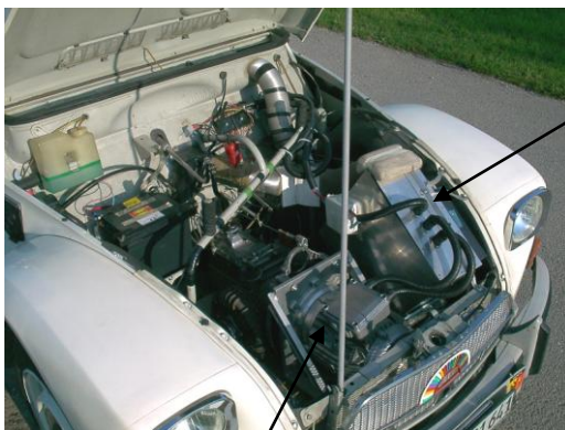
Moteur (traction) / Générateur (freinage) Électrique (12 KW)
